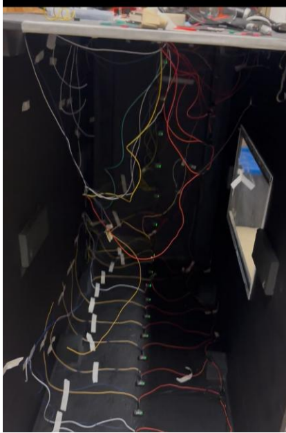
Fig 15.0 Actual array of 30 Lux Sensors
